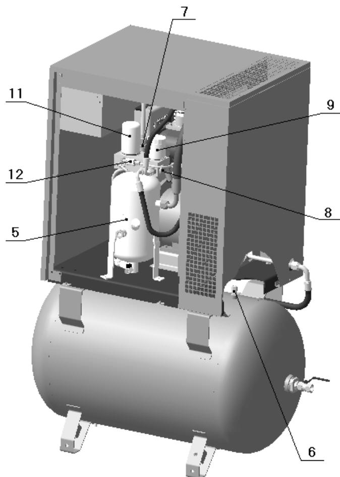
Рисунок 2 – Общий вид компрессорной установки ВК5Е-...-270, ВК7Е-...-270, ВК10Е-...-270
