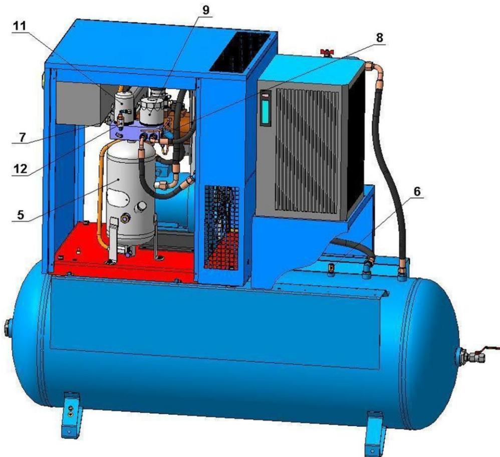
Рисунок 3 – Общий вид компрессорной установки ВК5Е-...-500(Д), ВК7Е-...-500(Д), ВК10Е-...-500(Д)
