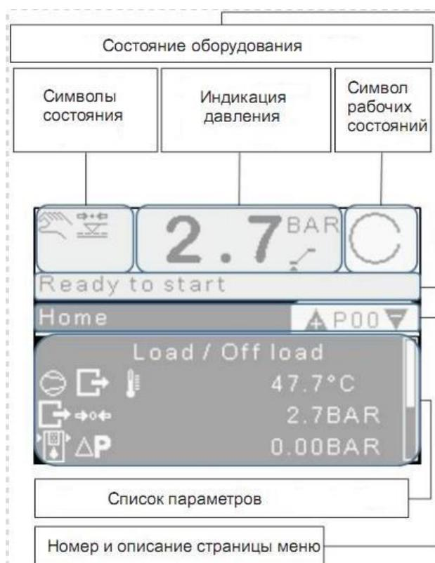
Рис. 1. Дисплей контроллера
