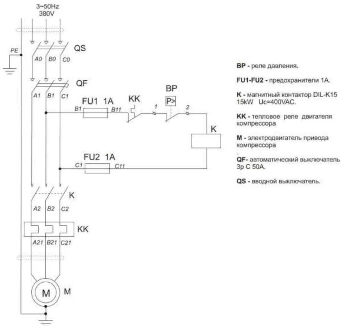
Рисунок А.1 - Схема электрическая принципиальная компрессоров
