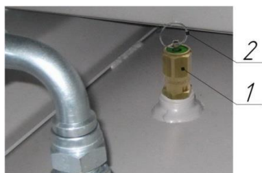
Рисунок 9 – Клапан предохранительный пружинного типа
