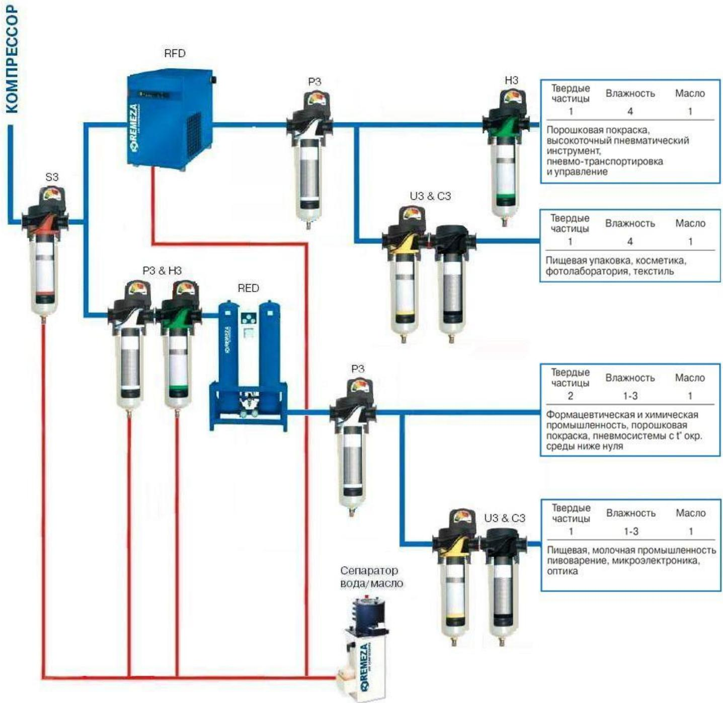
Рис. 5 Схема комплектной компрессорной станции
