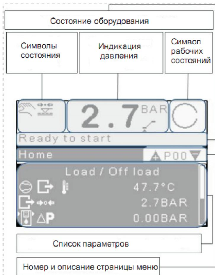
Рис. 1. Дисплей контроллера
