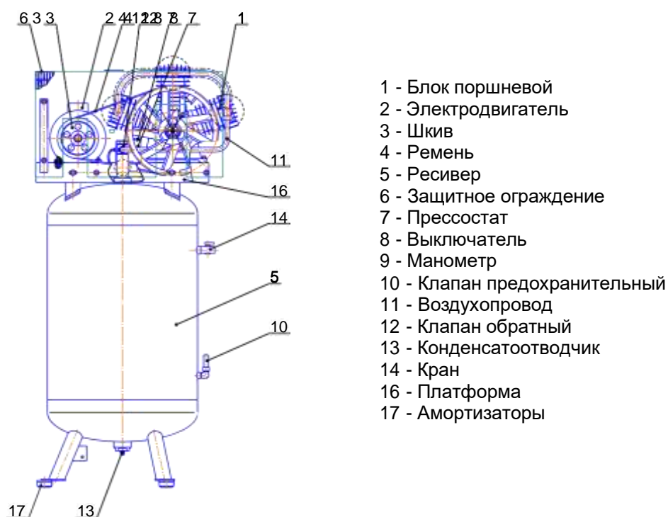
Рисунок 10 - Общий вид компрессора СБ4/Ф-270.LB40В
