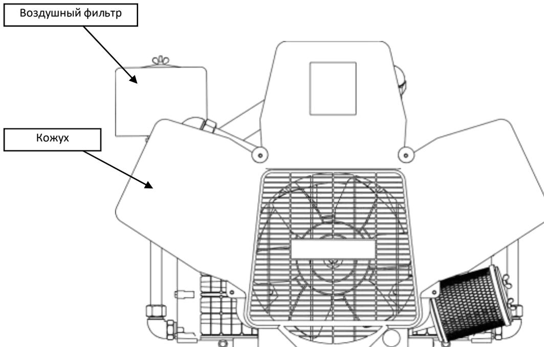
❖ Все компоненты, за исключением воздушного фильтра и кожуха очень сильно нагреваются в процессе работы компрессора. Перед проведением технического обслуживания подождите, пока они остынут.
