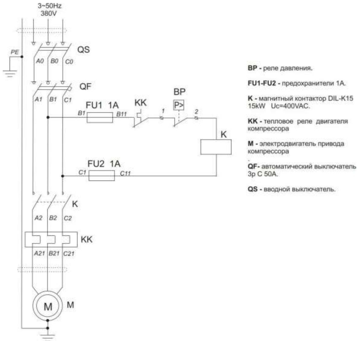
Рисунок А.1 - Схема электрическая принципиальная компрессоров
