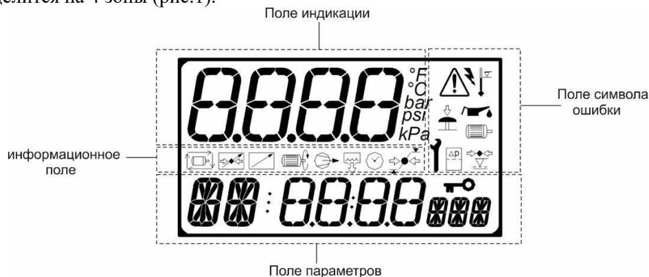
«**Поле индикации**» - четырехзначный цифровой 7-ми сегментный код, используется для постоянного отображения давления воздуха в сети в нормальном рабочем режиме или номер страницы меню в режиме программирования.
