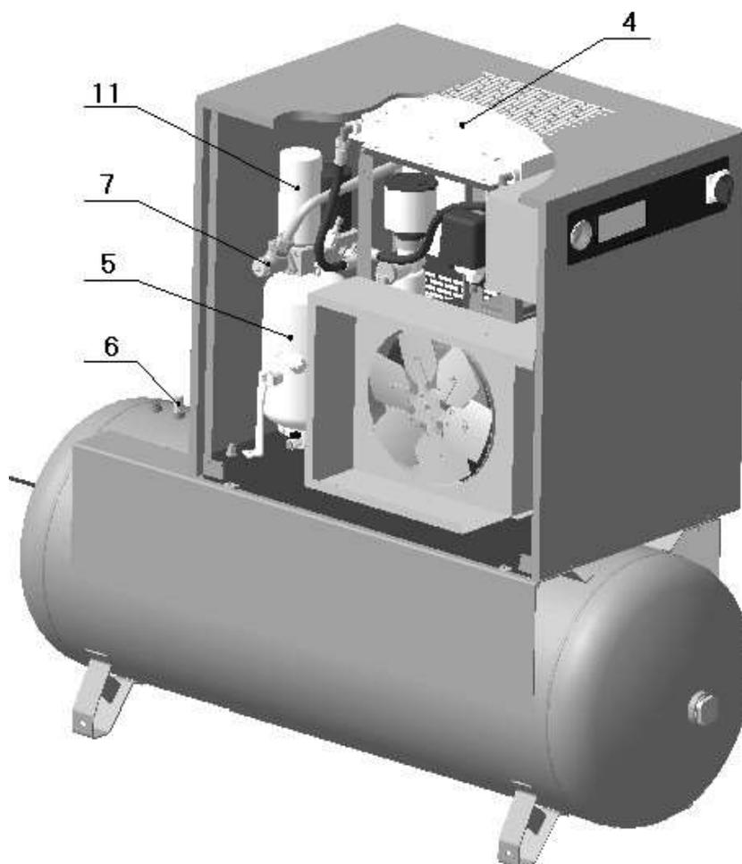
Рисунок 2 – Общий вид компрессорной установки BK15T-...-500
