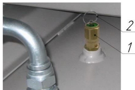
Рисунок 11 – Клапан предохранительный пружинного типа
