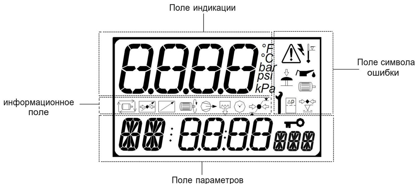
Рис. 1. Дисплей контроллера
